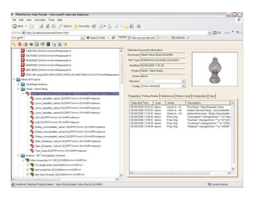
PDMWorks gestiona las revisiones de diseño y captura automáticamente el historial de todas las revisiones.
