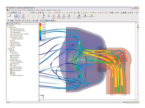
COSMOSFloWorks ha permitido que los ingenieros determinen el diseño óptimo para un nuevo dispositivo de suministro de oxígeno.
