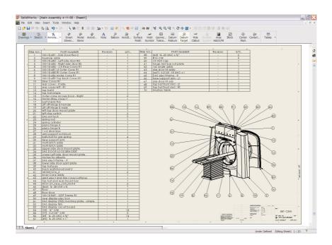
Con el software de SolidWorks, podrá generar automáticamente una lista de materiales, que podrá exportar como hoja de cálculo Excel o en otros formatos para importarla en sistemas MRP.
