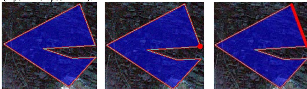
Для создания сложных объектов (например, для вырезания «островов» в площадных объектах, или создания сложной линии из нескольких несвязанных линий) объект, к которому добавляется новый элемент, сначала выделяется, затем создается новый элемент, и после завершения его создания программа спрашивает, следует ли его добавить к выделенному. Для редактирования объектов их предварительное выделение не обязательно.
